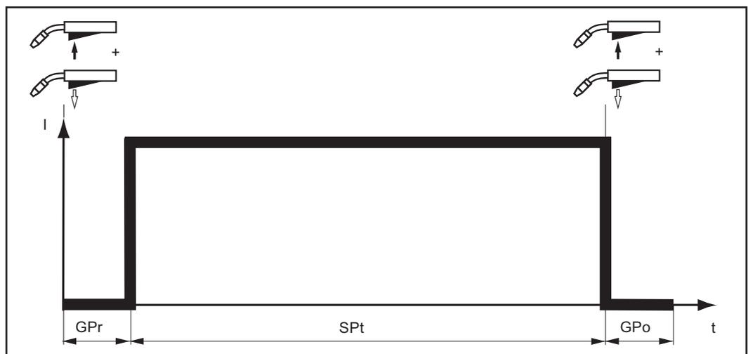
Premendo nuovamente il tasto della torcia è possibile interrompere anticipatamente il processo di saldatura.
